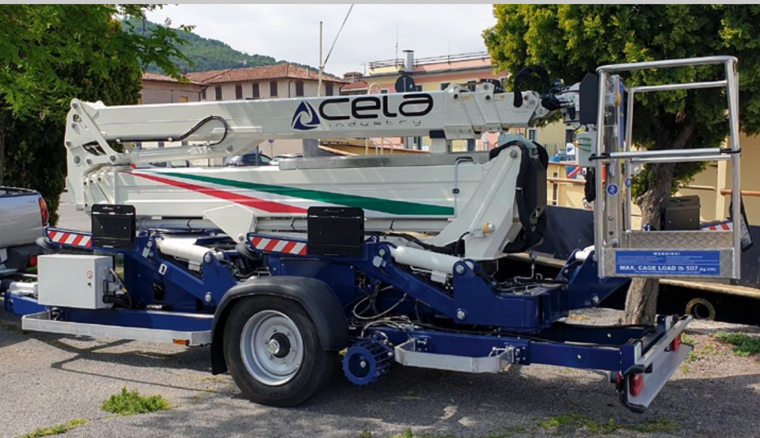
Das Modell DT-25 wurde bereits für LKW wie auch für Raupenfahrgestell adaptiert und ist nun auch als Anhängerbühne bei Cella erhältlich
